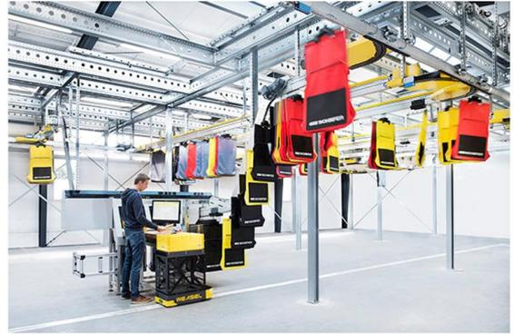
*Exemple d'un « pocket sorter » de la zone V (à gauche) et d'un poste d'injection du « pocket sorter » (à droite)*
